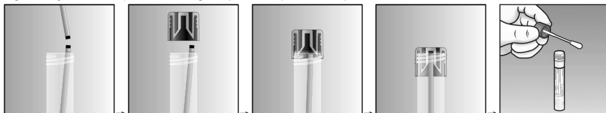
Fig 2. Fixação da haste partida do zaragatoa partido da parte da tampa do tubo de ensaio MSwab™
