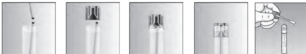
Fig. 3. Presa dell'asta spezzata del tampone da parte del tappo della provetta FecalSwab™
