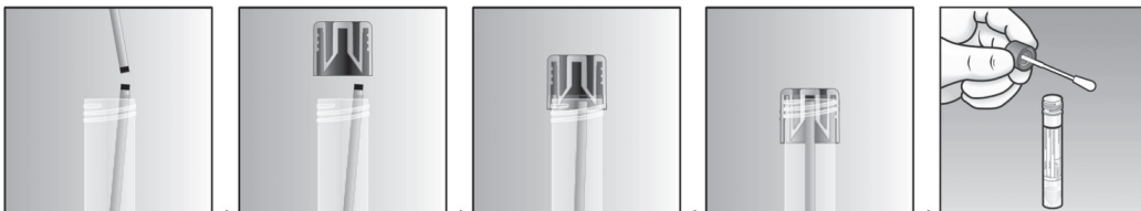
Fig. 3. Fixação da haste partida da zaragatoa pela tampa do tubo FecalSwab
