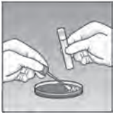
Fig. 4. Procedure per l'inoculazione di campioni FecalSwab™ su terreno solido agar in piastre di Petri
