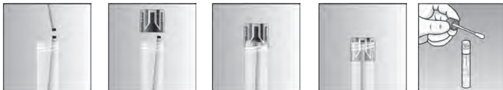
Fig. 3. Fixação da haste partida da zaragatoia pela tampa do tubo FecalSwab™
