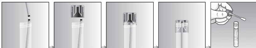
Obr. 1. Zachytenie zlomenej tyčinky aplikátora tampónu uzáverom skúmavky UTM-RT®
