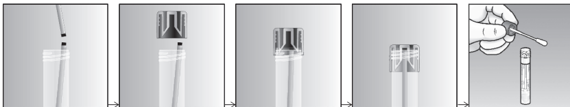
Fig 1. Podepindsapplikatorens knækkede skaft fanges af UTM-RT®-rørets hætte
