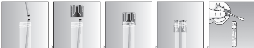
Фиг. 1. Улавяне на счупен апликатор на тампон с капачка за епруветка UTM-RT ®
