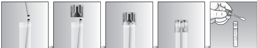
Рис. 1. Фіксація зламаного стрижня зонд-тампона у ковпачку пробірки з UTM-RT®
