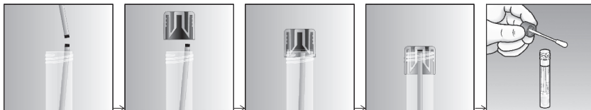
Fig. 1. Ancoraggio dell'astina del tampone nel tappo della provetta UTM-RT ®
