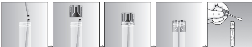
Εικ. 1. Σύλληψη του σπασμένου άξονα του βαμβυκαφόρου στειλεού από το πώμα σωληναρίου UTM-RT ®
