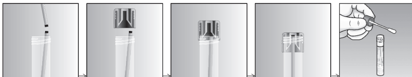
Fig. 1. Captura da haste partida do aplicador da zaragoato pela tampa do tubo UTM-RT ®
