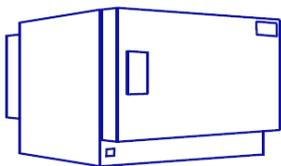
Recargue el gel de sílice secándolo en un horno de laboratorio a 60 – 65°C durante 24 horas, hasta que se vuelva amarillo.
