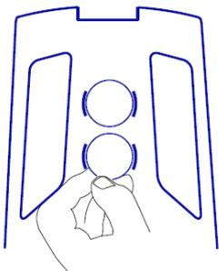
Retire la cápsula de gel de sílice levantando por detrás.
