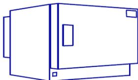
Recharger le gel de silice par séchage dans une étuve de laboratoire entre 60 et 65°C pendant plus de 24 heures, jusqu'à ce qu'il retrouve sa coloration jaune.
