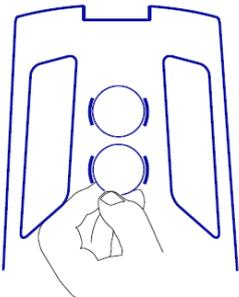
Retirer la capsule de gel de silice en la soulevant de l'arrière.
