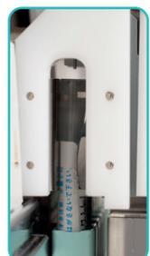
Beim Zusammendrücken der Probenröhrchen werden die Proben in die obere Probenkammer gefiltert und anschließend durch die Probenadel des Analyse-Gerätes aufgenommen.
